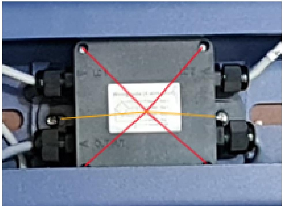
Dopo aver rimosso il coperchio, si scopre un terminale di connessione. Qui è possibile scollegare il cavo difettoso e collegare il nuovo nello stesso modo.
