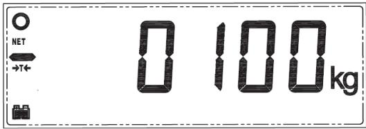
Sobald Sie das ganze Gewicht von der Wiegeplattform entfernen, wird der Anzeiger das Eigengewicht in negativ anzeigen.
