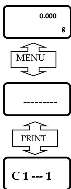
In modalità di pesatura, prima premere il tasto MENU, poi il tasto PRINT e comparirà il primo elemento del menu "C1" con la configurazione attuale.
