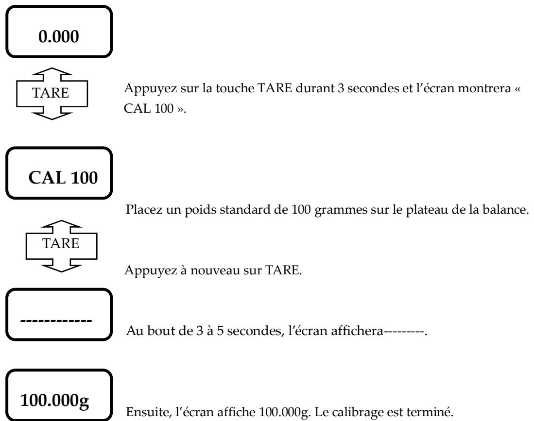
L'appareil revient en mode de pesée normale après un calibrage réussi.
